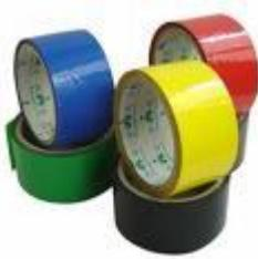
До просоченим волокнистим матеріалів відносять: лакотканини, лакобумаг, лаковані трубки і ізоляційні стрічки. Лакотканини широко застосовують для ізоляції в електричних машинах, апаратах, кабельних виробах у вигляді обмоток, обгорток, прокладок. Різновидом лакотканин є склопакана, у якої в якості основи використовується скловолокно. Недоліком лакобумаг є низька механічна міцність.
